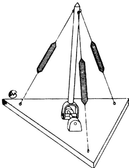
Рис. 28. — Схема расположения мышечных растяжек при двухосном сочленении.
