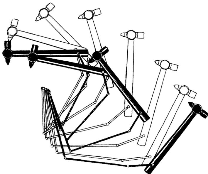
Рис. 76. Последовательные положения правой руки с молотком при рубке зубилом. Продольные оси плеча, предплечья и кисти изображены условно прямолинейными звеньями. Белые звенья и молотки—замах, черные—удар. Промежуток времени между смежными положениями— $\frac{1}{15}$  сек. Удар близок к нормали 8.
