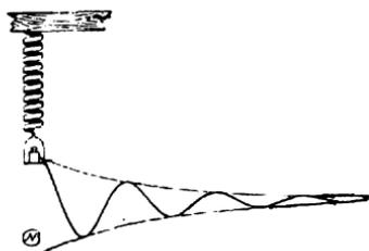
Рис. 12. Как выглядят затухающие колебания пружины, выведенной из равновесия грузом. Совершенно сходно выглядит и затухающее колебание мышцы (рис. 13) только затухание там быстрее.
