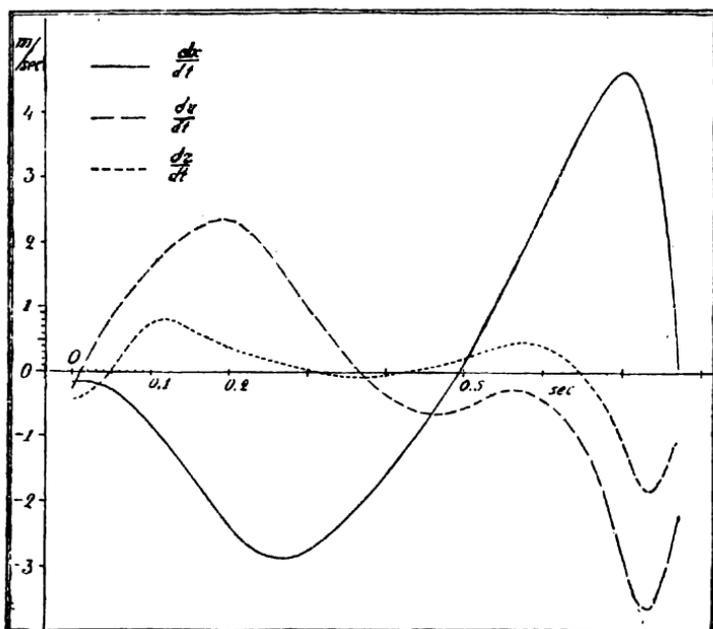
Рис. 72. График слагающих скоростей движения молотка при рубке зубилом.
