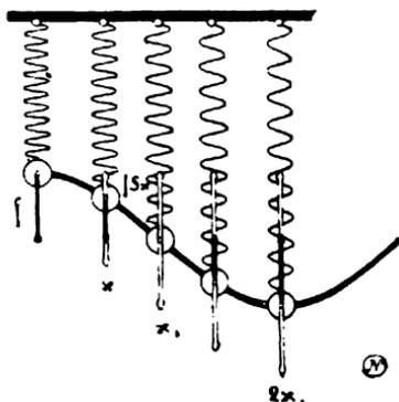
Рис. 11. Растяжение пружины грузом.
